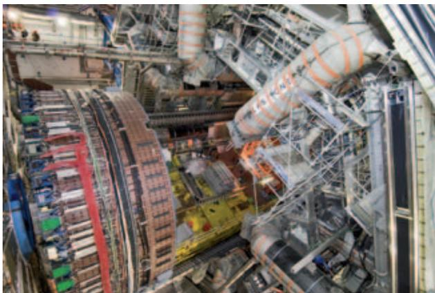
**Foto 1.** Una vista parcial de ATLAS, uno de los detectores del LHC, en su subterráneo punto de colisión, durante su ensamblaje. Atlas mide 25 m de alto y 46 de largo y pesa 7.000 toneladas, casi como la torre Eiffel. El detector incluye 3.000 km de cables y tiene 100 millones de canales electrónicos, además de incontables componentes de variadas tecnologías de punta. Fuente: CERN.
