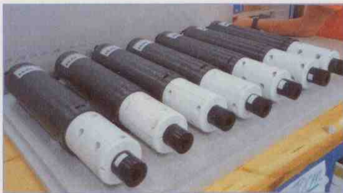
Posicionadores acústicos desarrollados por MSM para el proyecto KM3NeT.
